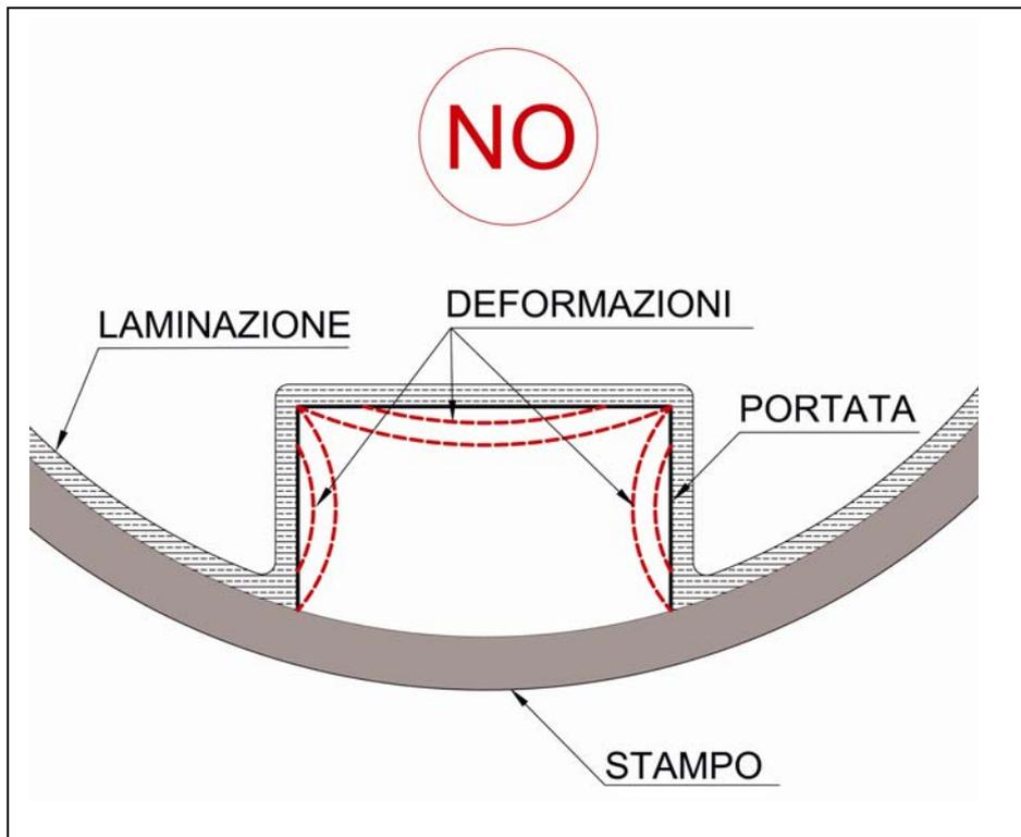
FIGURA 9 – PERICOLO DI DEFORMAZIONE DELLE PORTATE
